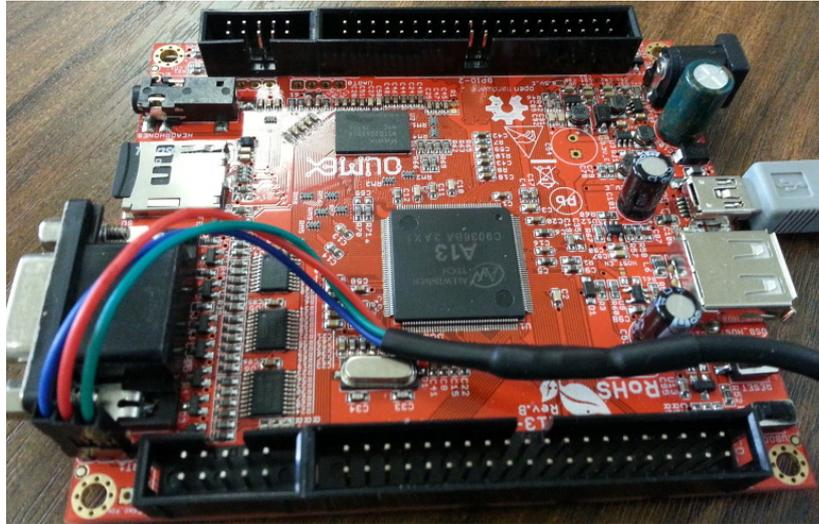
FIGURE 1 – Carte Olinuxino A13 micro équipée de son câble de communication RS232-USB. Noter l'ordre des couleurs des fils de liaison. Dans ce contexte, le câble USB gris ne sert qu'à alimenter la carte Olinuxino A13 micro.
