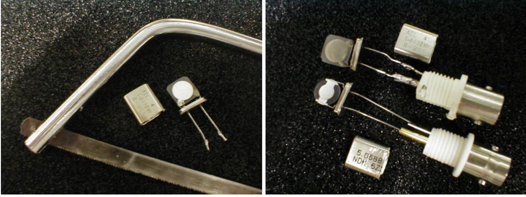
FIG. 1 – Gauche : résonateur à quartz après extraction de son boîtier. Une petite scie à métaux sert à couper le boîtier métallique juste au-dessus de la base. Entailler d’abord les deux petits côtés cylindriques, puis un des long côtés rectilignes. Prendre alors un soin particulier en sciant le dernier côté long à ne pas tordre le boîtier sous peine d’endommager le résonateur. Droite : deux résonateurs extraits de leurs boîtiers et prêts à l’emploi après soudure à un connecteur femelle BNC.
