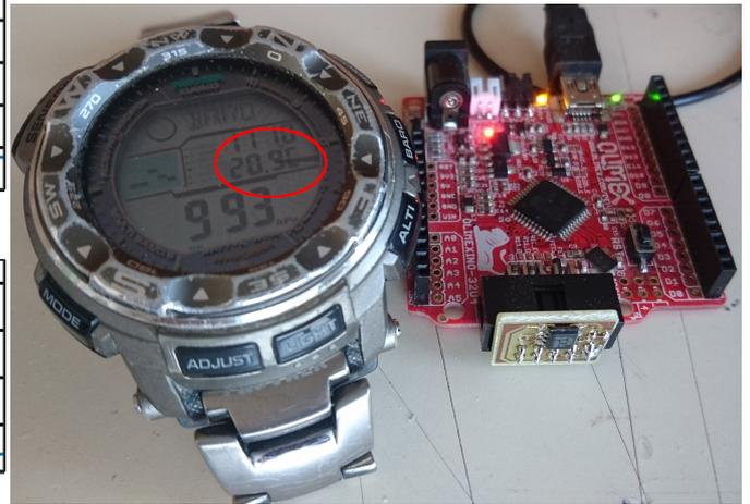
Le point de départ de la mesure est en accord avec l'information fournie par le capteur d'une montre possédant un capteur de température (droite).
