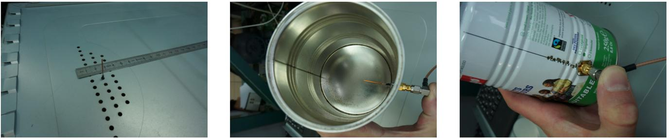
FIGURE 10 – Gauche : monopôle sur son plan métallique. Milieu et droite : monopôle dans une boîte de conserve utilisée comme guide d’onde.
