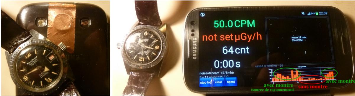
FIGURE 11 – Montage pour la détection de rayonnements ionisants par le capteur optique d’un téléphone mobile : la lentille est couverte d’un scotch métallisé opaque à la lumière. Droite : mesure en cours en présence d’une source de rayonnement qu’est une montre aux aiguilles couvertes de radium.
