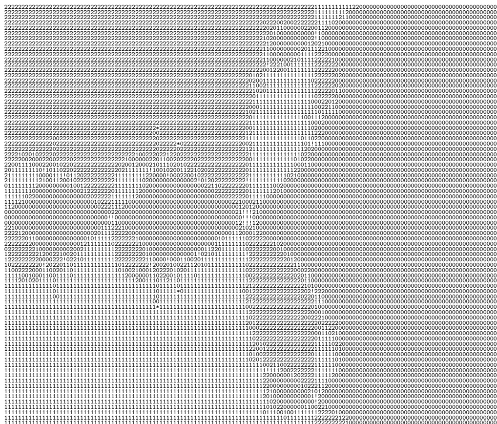
FIGURE 6 – Fractale de Newton calculée sur des nombres entiers sur 32 bits pour une partie réelle comprise entre -1,4 et +1,44 par pas de 0,02 et une partie imaginaire de -0,8 à 0,8 par pas de 0,02.
