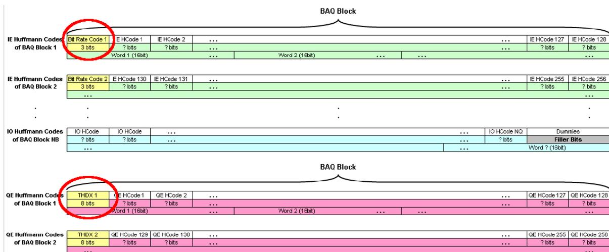
FIGURE 8 – En haut les coefficients I pairs (IE) sont préfixés du facteur de compression BRC définissant l’arbre de Huffman à suivre pour décoder les valeurs, et en bas les Q pairs (QE) sont préfixés du facteur de quantification THIDX qui seront appliqués à tous les éléments de la ligne correspondante I et Q. Tout le tableau doit donc être analysé avant de fournir les valeurs résultant du décodage.
