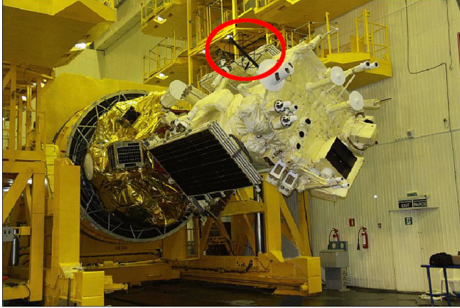
FIGURE 1 – Gauche : photographie de Meteor-M2 présentant son antenne omnidirectionnelle VHF émettant en polarisation circulaire, prise sur directory.eoportal.org/web/eoportal/satellite-missions/m/meteor-m-2 . Droite : bilan de liaison radiofréquence reliant la puissance émise P_e à la puissance reçue P_r ou P'_r d'une part, et d'autre part le bruit thermique N complété de la contribution du récepteur F , avec le rapport signal à bruit nécessaire pour atteindre moins d'un bit erroné pour un million de bits transmis lorsque le satellite est à l'azimut (rouge, distance de 825 km du récepteur) et à l'horizon (vert, distance de 3350 km du récepteur), justifiant des codes correcteurs d'erreur. L'écart entre le rapport signal à bruit fourni sur ce graphique (13,5 et 5,5 dB) et l'axe des abscisses de la Fig. 7 vient de l'efficacité spectrale qui relie ces deux grandeurs, soit 10 \log_{10}(2) = 3 dB pour QPSK.
