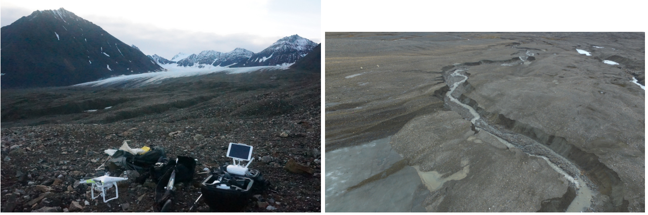
FIGURE 1 – Gauche : conditions expérimentales : le DJI Phantom3 répond aux exigences de facilité de transport, de déploiement rapide, d'autonomie et de couverture du champ de vision de la caméra. Il s'est avéré idéal pour cette campagne de mesures. Droite : canyon dans la moraine du glacier étudié, qui sera au cœur de l'étude car proposant des structures identifiables susceptibles de varier à court terme. La langue du glacier est visible en bas à gauche de cette photographie.
