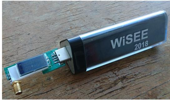
FIGURE 5 – Montage utilisé pour les tests : l’antenne a été remplacée par un connecteur SMA pour les mesures en mode conduit sur analyseur de spectre. Ce connecteur rayonne suffisamment pour démontrer le brouillage de GPS sur un rayon de quelques mètres sans risquer d’affecter les récepteurs à grande distance. Le circuit est alimenté par une batterie fournissant 5 V sur un connecteur USB.
