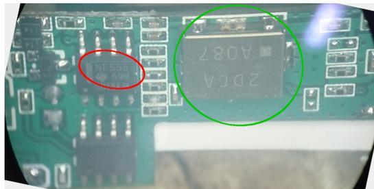
FIGURE 3 – Le circuit du brouilleur GPS : un NE555 (rouge) polarise la tension de commande de l’oscillateur (vert) qui, suivi d’un amplificateur monolithique, émet 10 dBm. Le circuit intégré en bas d’image, non identifié, polarise les cristaux liquides d’un afficheur qui ne sert à rien d’autre que faire croire à l’utilisateur qu’il “bloque” (brouille) la bande L2, mais il n’en est rien puisque l’excursion de la source micro-onde est (heureusement) insuffisante.
