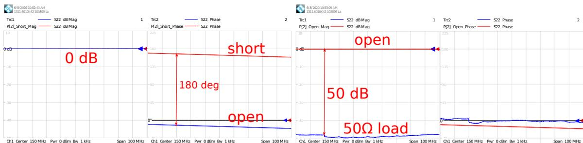
FIGURE 9 – Comparaison en cours de l'étalonnage de la réponse de la charge  $50 \Omega$  de référence par rapport au circuit ouvert, et du circuit ouvert par rapport au court-circuit. Noter que dans ce second cas le module est le même (réflexion totale donc  $|S_{11}| = 1 = 0$  dB) mais la phase a tourné de  $180^\circ$  entre les deux mesures.
