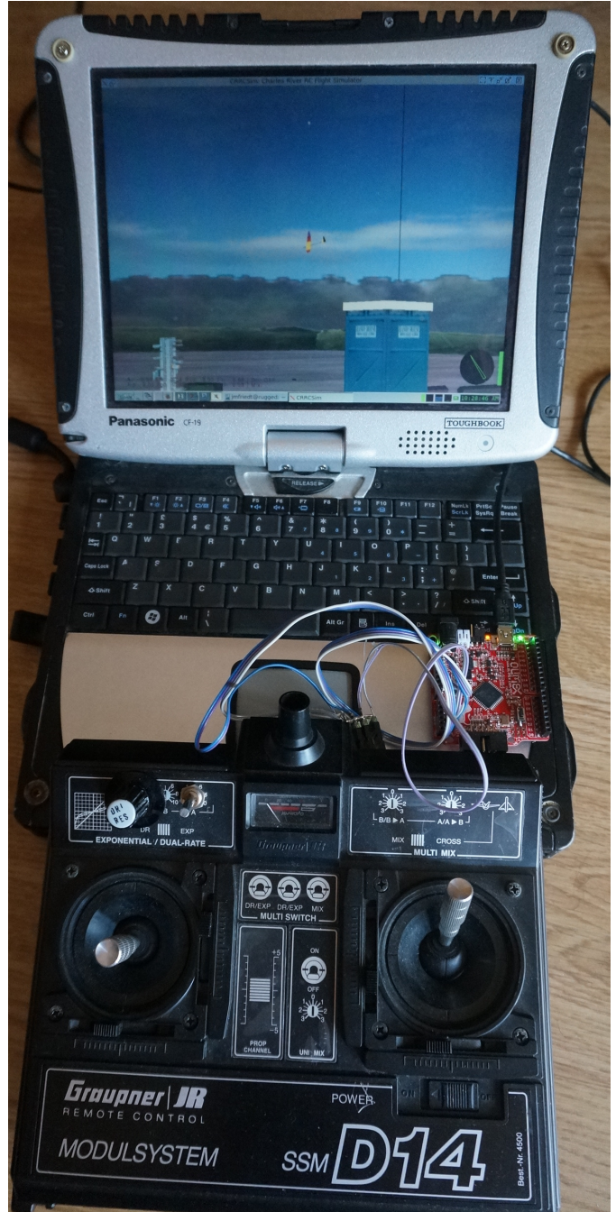
Figure 1: Montage final, avec la radiocommande pilotant le simulateur de vol crrcsim
