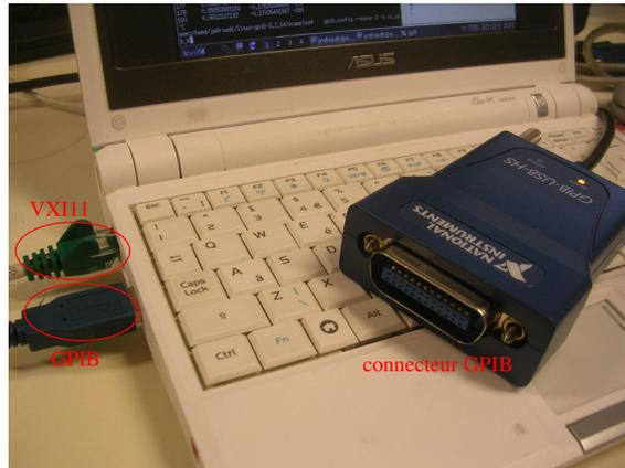
FIG. 1 – Interface USB-GPIB sur eeePC701 : ce type d’interface, tout comme l’interface ethernet pour communiquer avec les instruments supportant le protocole VXI11, permet d’automatiser l’acquisition de données quelque soit l’emplacement de l’instrument dans un laboratoire. Au-delà de l’automatisation des mesures, la mise en œuvre d’une expérience complexe regroupant plusieurs instruments impose des contraintes de distances telles que décrites dans le texte.
