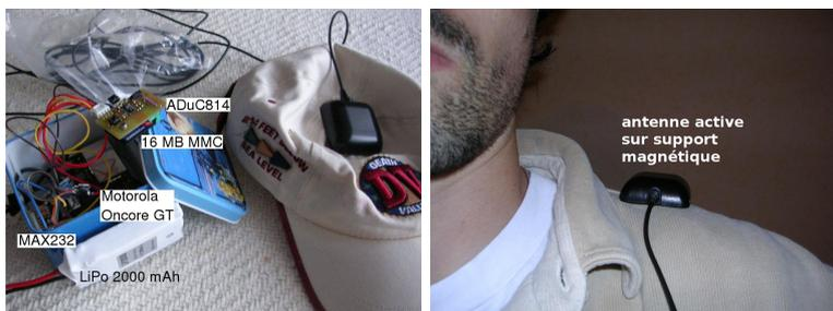
FIG. 4 – Exemples de montage pour l’acquisition de données GPS lors de randonnées : le montage est installé dans une petite boîte fermée protégeant l’électronique des chocs extérieurs (notamment risque d’appui sur l’interrupteur de RESET du microcontrôleur) tandis que l’antenne à support magnétique est placée en vue directe du ciel.
