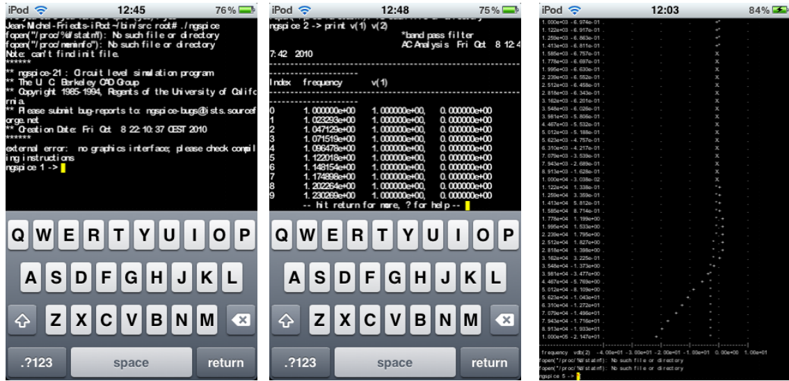
FIG. 2 – Exécution de ngspice sur iPod Touch dans le MobileTerminal : à gauche le lancement du logiciel de simulation du comportement de circuits électroniques, et à droite la solution pour deux potentiels d’un circuit après simulation. Malgré l’absence d’interface graphique pour SPICE, la sortie en ASCII au moyen de asciipLOT est exploitable.
