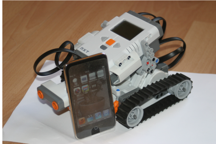
FIG. 14 – La brique NXT reçoit des commandes de l'iPod Touch générées à partir des signaux lus sur ses accéléromètres : ainsi, pencher l'iPod dans une direction incite le robot à se déplacer dans cette direction.
