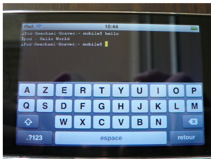
FIG. 1 – Exécution d'une application POSIX dans le MobileTerminal de l'iPod Touch, application compilée au moyen de la toolchain mise en place sur plateforme x86.
