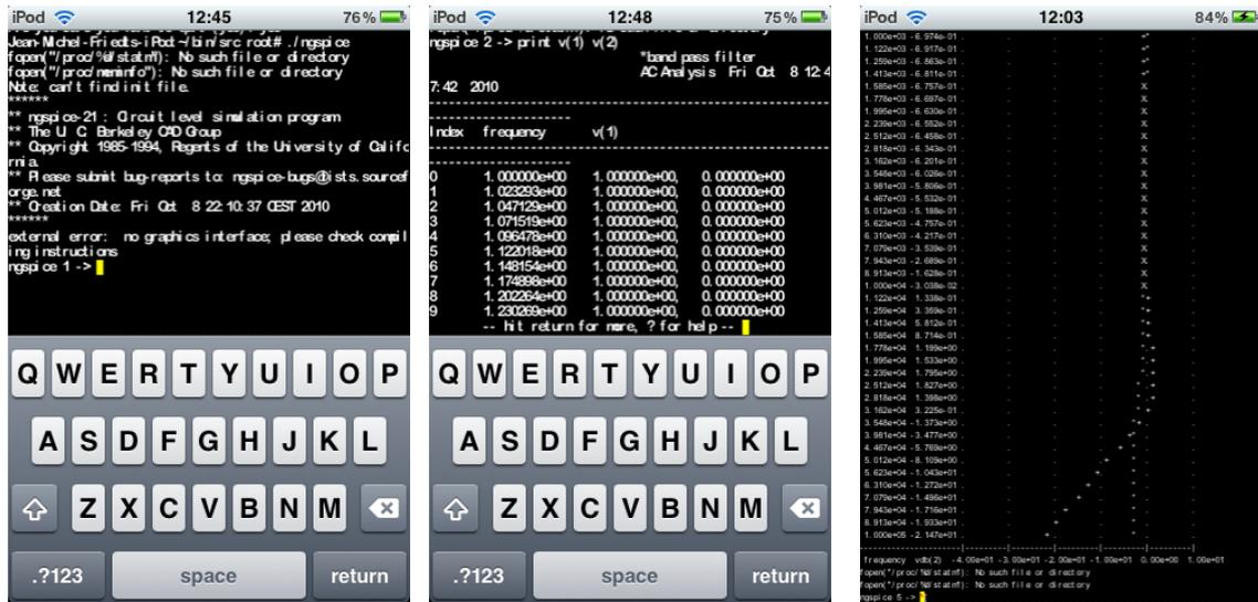
FIG. 2 – Exécution de `ngspice` sur iPod Touch dans le `MobileTerminal` : à gauche le lancement du logiciel de simulation du comportement de circuits électroniques, et au milieu la solution pour deux potentiels d'un circuit après simulation. Malgré l'absence d'interface graphique pour SPICE, la sortie en ASCII (droite) au moyen de `asciiplot` est exploitable.
