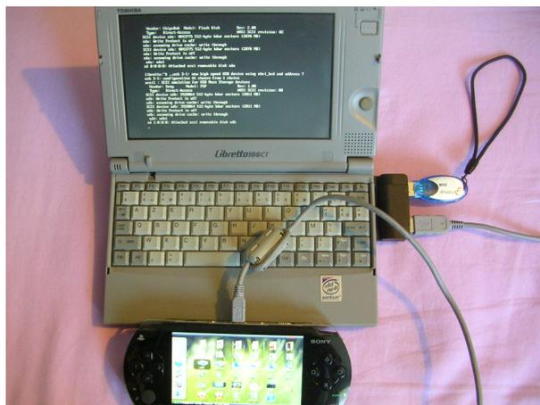
FIG. 1 – Connexion de la PSP à un ordinateur portable sous Debian GNU/Linux sur lequel est installé le PSP SDK : la console apparaît comme un support de stockage de masse sur le bus USB.
