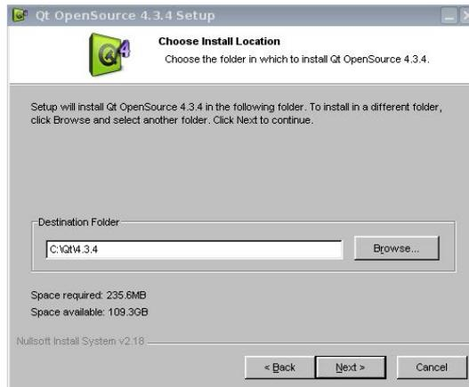
FIG. 2 – Installation de Qt pour Windows avec wine : cette fenêtre s’obtient par `wine qt-win-opensource-4.3.4-mingw.exe`.
