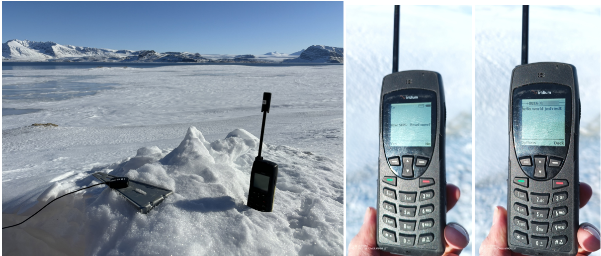
FIGURE 10 – Gauche : montage expérimental, avec l’antenne GPS modifiée pour la réception d’Iridium en vue du ciel (et des glaciers à front marin de Kongsfjorden), le téléphone incitant les satellites à communiquer vers notre site, et milieu-droite les messages textuels reçus par le téléphone.
