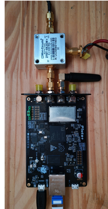
FIGURE 11 – Gauche : chaîne d’acquisition de la Pluto+ : noter en commentaire la fréquence centrale de 1624,5 MHz qui permet à la Pluto+ de recevoir la moitié supérieure de la bande Iridium mais qui n’est pas celle qui contient les SMS, tandis que le bloc décommenté centre l’oscillateur local sur 1620,5 MHz et la bande passante sur le maximum accessible sans perte de données de 5 MHz. Droite : Pluto+ et son T de polarisation pour alimenter le préamplificateur au plus proche de l’antenne dans la base Jean Corbel de l’IPEV, 78,9°N. Seule l’entrée gauche est utilisée pour Iridium, l’antenne 868 MHz sur l’entrée droite sert de détrompeur et pour observer les trames du réseau de capteurs LoRa.
