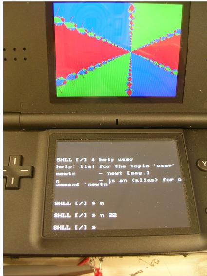
FIG. 11 – Une nouvelle commande pour le shell RTEMS : le calcul de la fractale de Newton (illustrant au passage l’émulation du calcul sur nombre à virgule flottante et l’affichage sur framebuffer) par `newtn`.
