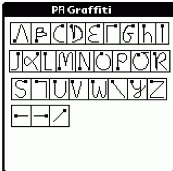
FIG. 10 – Ordre de calligraphie des caractères afin d’être reconnus par la PALib exploitée par RTEMS pour recevoir des caractères de l’utilisateur. Noter que la reconnaissance des caractères est activée par l’appui du bouton L de la console et en écrivant simultanément sur l’écran tactile de la DS.
