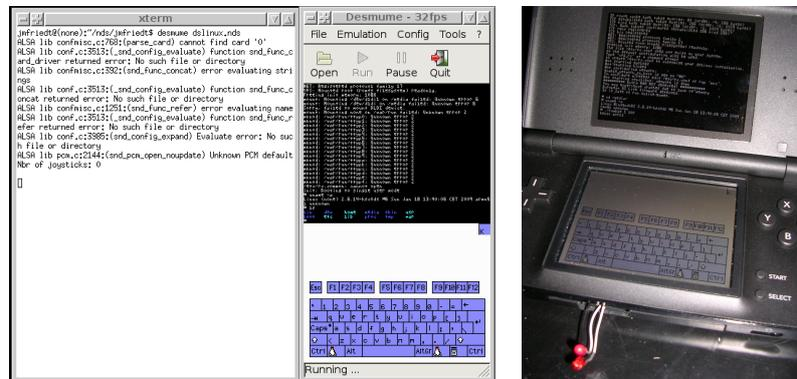
FIG. 1 – Gauche : DSLinux fonctionne parfaitement sur l’émulateur `desmume`, facilitant ainsi le développement sur PC avant l’exécution sur la console de jeu elle-même. Droite : résultat similaire sur la console, déjà équipée de LEDs (section 5).
