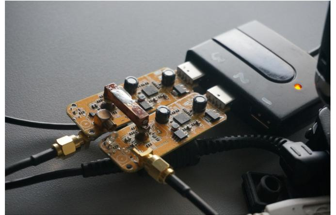
FIGURE 5: Montage expérimental : deux récepteurs DVB-T acquièrent simultanément l'un le signal de référence, l'autre le signal de mesure. Le quartz du second récepteur a été dessoudé et la sortie de l'oscillateur du premier circuit cadence le second : un condensateur de l'ordre de la dizaine de nF relie la sortie du premier oscillateur à l'entrée du second. Un pont thermique formé d'un barreau de cuivre vise à équilibrer la température des deux étages de réception radiofréquence.
