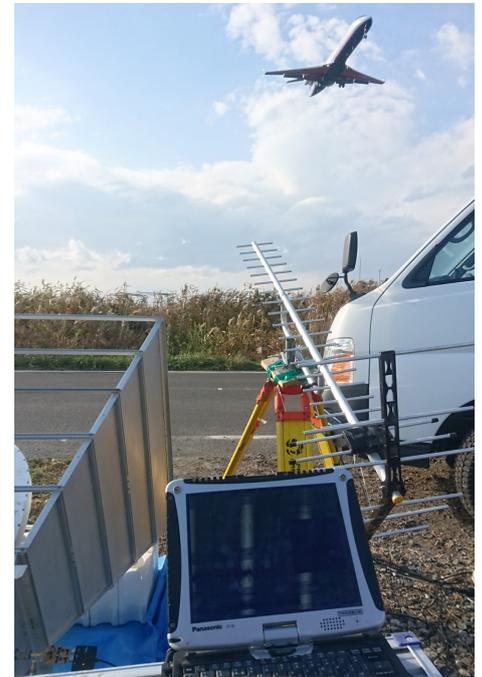
FIGURE 12 – Gauche : trajectoire dans le plan distance-vitesse de l'avion au cours de son approche et atterrissage, obtenue en sommant les clichés visibles sur la Fig. 11. Droite : conditions expérimentales, avec l'antenne Yagi-Uda pointant vers la cible.
