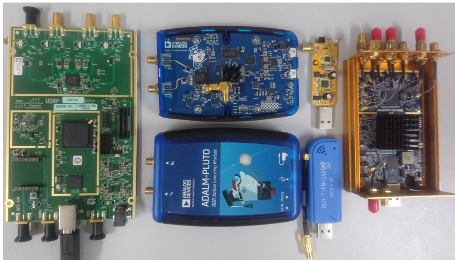
FIGURE 1 – Les diverses plateformes testées dans cet article : de gauche à droite, l’Ettus Research B210, la PlutoSDR d’ADi, les récepteurs DVB-T, et la LimeSDR. La plateforme HackRF, présentée dans [1], n’était pas disponible pour ces tests.
