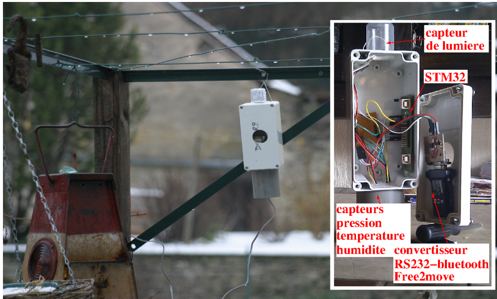
FIGURE 5 – Vue intérieure de la station et installation en extérieur. La liaison sans fil avec l'ordinateur chargé de placer les informations recueillies sur le web se fait par Bluetooth.
