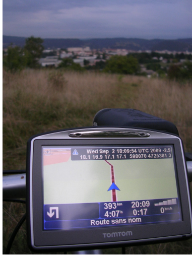
FIG. 10 – Exploitation du Tomtom Go720 fixé sur le guidon d'un vélo, mettant à jour toutes les 10 secondes les 4 estimations de température de la jante (ici, 18,1, 16,9, 17,1 et 17,1 degrés) et la position du récepteur (ici 5,98 degrés est, 47,25 degrés nord) sur l'interface de navigation fournie avec l'instrument. Ces informations sont par ailleurs stockées en mémoire non-volatile pour post-traitement.
