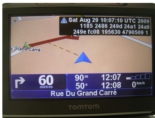
FIG. 9 – Affichage des données acquises (la résistance de référence, 5 résistances des sondes Pt100 et l'estimation de la température par la diode interne au MSP430) précédés de la date et géoréférencées par les informations fournies par le récepteur GPS du Tomtom. L'affichage, en hexadécimal, retranscrit directement les informations obtenues du microcontrôleur.
